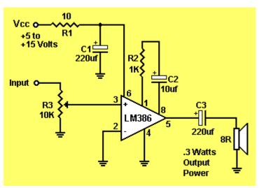
300mW amplifier using LM 386
