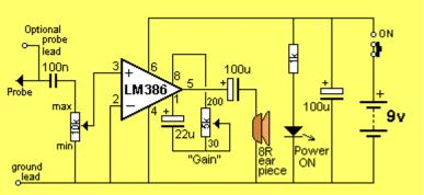
300mW amplifier using LM 386
